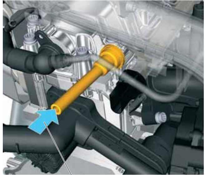
Luftzufuhr vom Luftfilter
